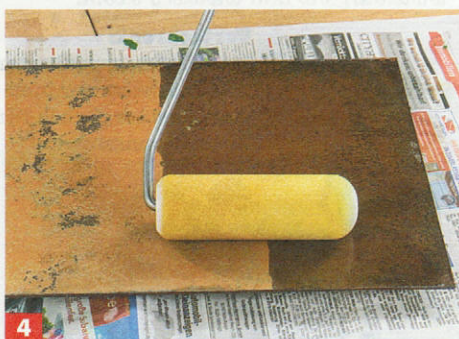
1 Stahl säubern/entfetten, glatte Oberfläche anschleifen. Den Schnellroster mit Schaumstoffwalze oder Schwamm auftragen.*
